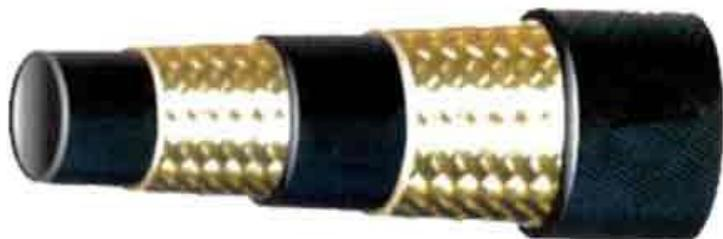
**Рукав высокого давления типа 2SC DIN EN 853** используется в гидравлических системах среднего давления с рабочей жидкостью на нефтяной основе, водно-гелиевой жидкостью, смазочными маслами, воздухом и водой. Для систем с воздухом, работающим под давлением, превышающим 1,7 МПа необходимо заказать **РВД** с перфорированным наружным слоем.
