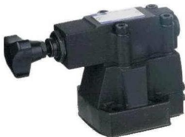
Гидроклапан МКПВ 10/3Т2Р2 трубного монтажа нормально открытый не прямого действия (сброс происходит непосредственно в гидробак или в общую линию слива) без электромагнитного управления (без разгрузки) Предназначен для регулировки давления гидросистемы в соответствии с заданными параметрами. В основном устанавливается в гидросистему после насоса, перед основными органами управления (гидрораспределителями), либо непосредственно перед рабочими органами.
