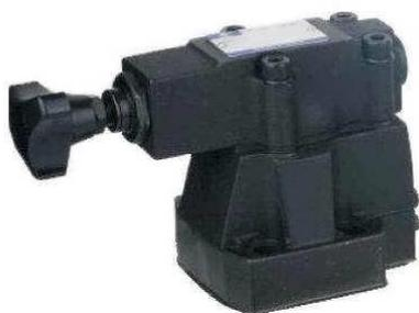
Гидроклапан МКПВ 10/3Т2Р1 трубного монтажа нормально открытый не прямого действия (сброс происходит непосредственно в гидробак или в общую линию слива) без электромагнитного управления (без разгрузки) Предназначен для регулировки давления гидросистемы в соответствии с заданными параметрами. В основном устанавливается в гидросистему после насоса, перед основными органами управления (гидрораспределителями), либо непосредственно перед рабочими органами.
