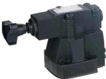
Гидроклапан МКПВ 10/3ТЗР1 нормально открытый не прямого действия (сброс происходит непосредственно в гидробак или в общую линию слива) с электромагнитным управлением (с разгрузкой). В качестве гидрораспределителя управления ВЕ6.574А. Предназначен для регулировки давления гидросистемы в соответствии с заданными параметрами. В основном устанавливается в гидросистему после насоса, перед основными органами управления (гидрораспределителями), либо непосредственно перед рабочими органами.
