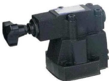
Гидроклапан МКПВ 10/3ТЗР2 нормально открытый не прямого действия (сброс происходит непосредственно в гидробак или в общую линию слива) с электромагнитным управлением (с разгрузкой). В качестве гидрораспределителя управления ВЕ6.574А. Предназначен для регулировки давления гидросистемы в соответствии с заданными параметрами. В основном устанавливается в гидросистему после насоса, перед основными органами управления (гидрораспределителями), либо непосредственно перед рабочими органами.
