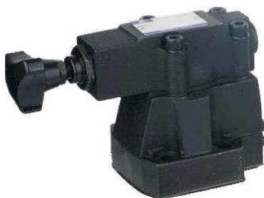
Гидроклапан МКПВ 10/3ТЗРЗ нормально открытый не прямого действия (сброс происходит непосредственно в гидробак или в общую линию слива) с электромагнитным управлением (с разгрузкой). В качестве гидрораспределителя управления ВЕ6.574А. Предназначен для регулировки давления гидросистемы в соответствии с заданными параметрами. В основном устанавливается в гидросистему после насоса, перед основными органами управления (гидрораспределителями), либо непосредственно перед рабочими органами.
