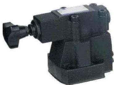
Гидроклапан МКПВ 10/3Т2Р3 трубного монтажа нормально открытый не прямого действия (сброс происходит непосредственно в гидробак или в общую линию слива) без электромагнитного управления (без разгрузки) Предназначен для регулировки давления гидросистемы в соответствии с заданными параметрами. В основном устанавливается в гидросистему после насоса, перед основными органами управления (гидрораспределителями), либо непосредственно перед рабочими органами.
