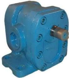
**Насосы АГ11-11Б** предназначены для нагнетания постоянного по величине и направлению потока минерального масла с кинематической вязкостью от 10 до 400 мм<sup>2</sup>/с при температуре масла 10...55°С в смазочные системы станков и других стационарных машин.
